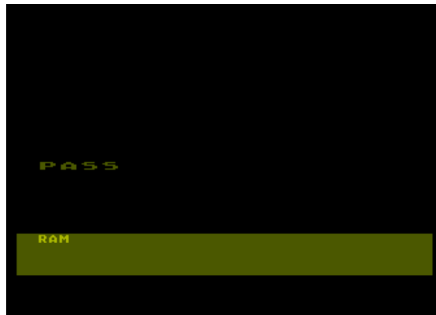
Figure 3-12. RAM Test 65XE OK.
