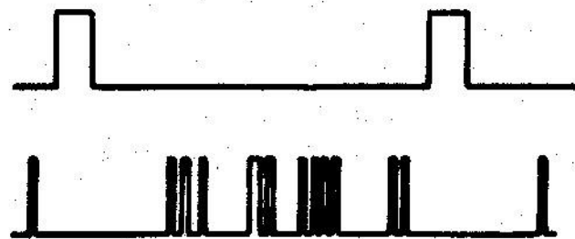
Fig 3: Exemple d'information numérique sur une ligne. En haut la synchro.
